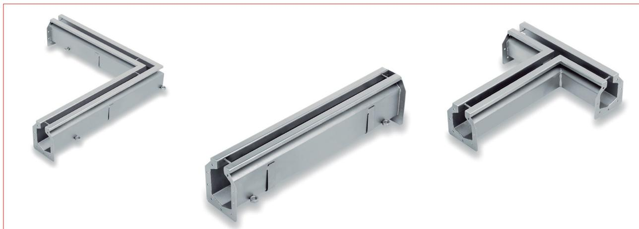
El canal se caracteriza por su sencillez de montaje. Los diferentes elementos del sistema se unen entre sí sin soldaduras. Únicamente se atornillan las pletinas que lleva incorporado cada elemento a unir, situando una junta de caucho entre los elementos, para garantizar su estanqueidad.
