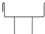
Canal ducha sin alas con salida libre o sumidero en acero inoxidable salida vertical
